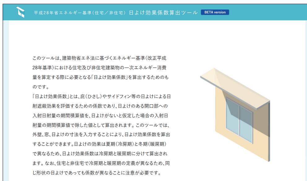
図 2.3.2.1 「日よけ効果係数算出ツール」専用プログラムの画面
